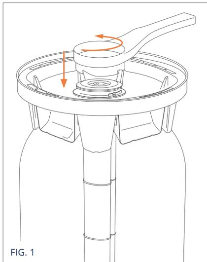
Schrauben Sie das Ventil mit dem entsprechenden Demontageschlüssel ab.
