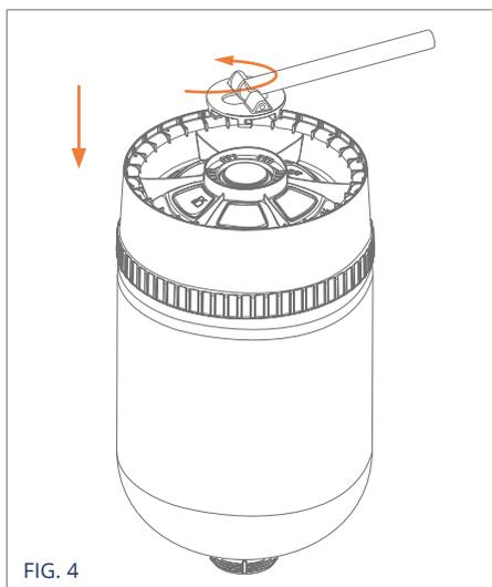
Befestigen Sie den Demontageschlüssel am Boden des Fasses und drehen Sie den Hebel um 180° gegen den Uhrzeigersinn.
