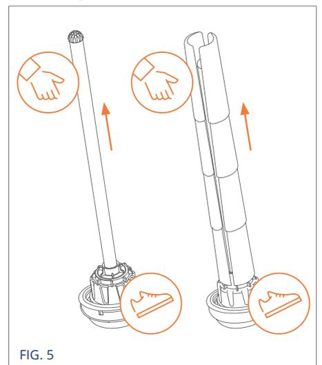
Trennen Sie das Ventil vom Saugrohr oder Beutel-Kit, indem Sie das Ventiltteil festhalten und das Saugrohr oder Beutel-Kit zu sich ziehen.
